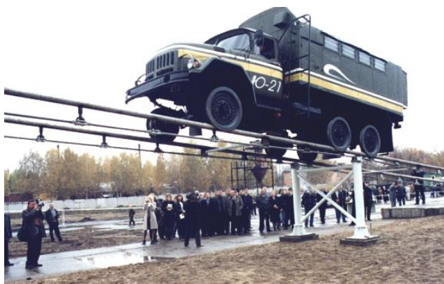
Obr. 46. Modifikovaný ZIL-131 na strunovo-koľajovom nosníku s dĺžkou 24 m
