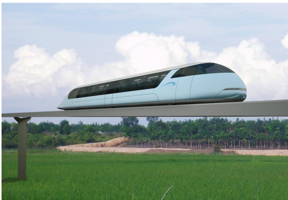
Obr. 26. Osobný vysokorýchlostný unibus (kapacita 36 cestujúcich, odhadovaná rýchlosť 360 km/h)
