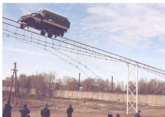
Obr. 47. Modifikovaný ZIL-131 na strunovo-koľajovom nosníku s dĺžkou 48 m
